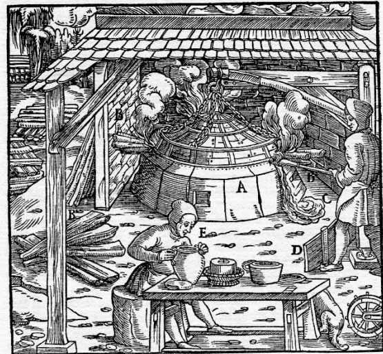
Der Ofen A. Die Holzschütte B. Die Silberglätte C. Das Blech D. Ein hungriger Meister isst Butter, damit das Gift, welches der Herd ausatmet, ihm nicht schadet; denn sie isst ein Spezialmittel dagegen E.
